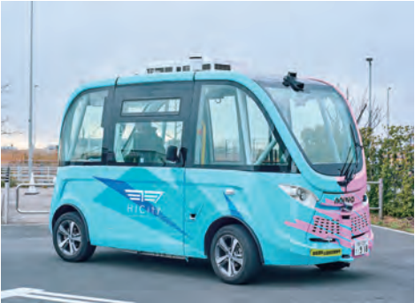
運転席はなく、GPSで位置を把握しながら設定したルートを自走。センサーで障害物や歩行者を検知する
